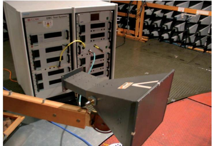
Abbildung 2 zeigt den Gesamtverstärker zusammen mit der Breitband Mikrowellenhorn-Sendeantenne. Beide zusammen decken den Mikrowellen-Frequenzbereich 800 – 4000 MHz für EMV-Komponenten- und Fahrzeug-Einstrahltests ab.
