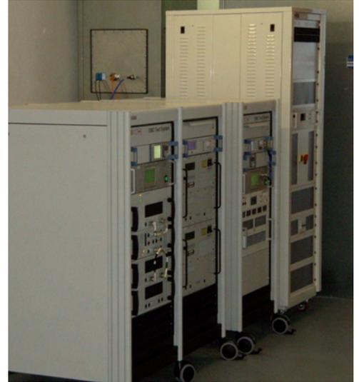
komplettes Verstärkersystem 100kHz-1GHz, 1kW
