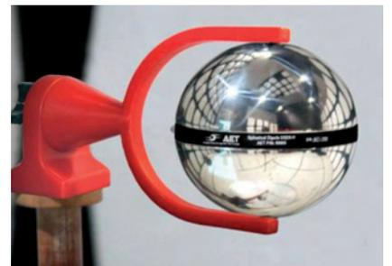
Die Universal Spherical Dipole Source von ETS-Lindgren hilft Ihnen Ihre Testumgebung ständig zu überprüfen und auf „Gleichheit“ zu testen. Durch das zur Verfügung gestellte, präzise Abstrahlprofil können Sie Ihren Messplatz regelmäßig mit früheren Profilen vergleichen und eventuellen Fehlmessungen vorbeugen. Ebenso findet die USDS für Messplatzvergleiche und Schirm-dämpfungsmessungen von kleinen Gehäusen (Kugeldurchmesser 10 cm) Ihren Einsatz. ■
