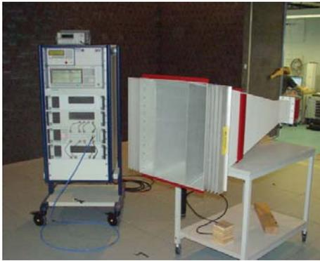
Felder bis 600V/m zu erzeugen, wie sie bei einigen automotive Teststandards gefordert werden. Das Modell 3162-01 deckt den relevanten Bereich von 1,1 - 1,5GHz und das Modell 3162-02 den Bereich 2,6 - 3,1GHz ab. Die bewusst schmalbandige Konstruktion verhindert Schwingungen, wie sie bei der Pulserzeugung mit breitbandigen Antennen zu beobachten sind.
