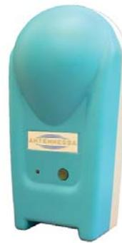
Das kleine am Körper zu tragende Gerät (nur 450g) hat eine Batteriebetriebsdauer von über 7 Tagen! Es werden Strahlungswerte in 12 festen Frequenzbändern vom UKW-Bereich bis zu UMTS aufgezeichnet. Als Besonderheit wird im GSM/UMTS Bereich zwischen Sendekanal (tx) und Empfangskanal (tr) unterschieden. Die Empfindlichkeit liegt bei 0,05V/m.
