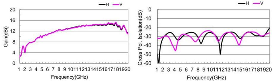
Die Hornantennen der LB-OSJ-Serie verfügen über einen sanften Gewinn, geringe Rückflussdämpfung / VSWR und eine gute Isolation. Weitere Vorteile dieser Antennen sind eine kompakte Bauform und ein geringes Gewicht. Ebenso erhältlich sind Hornantennen mit speziellem Gewinn gemäß den Anforderungen des Kunden.
