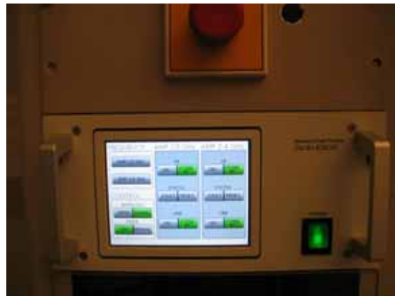
Abb. 2 – Remote-Touch-Screen Bedienpanel des Mikrowellen-Verstärker Gesamtsystems
